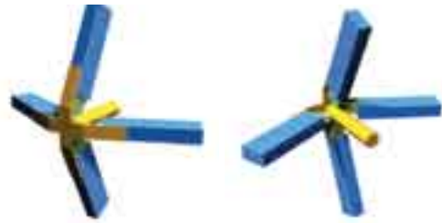
WRCクラディング用スチール支持構造の詳細
